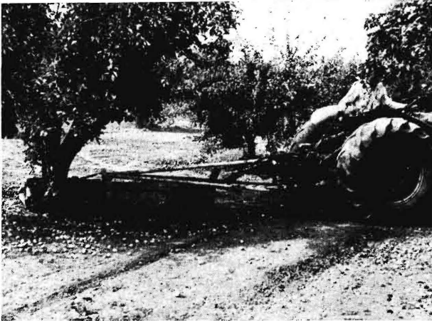
Bild 22. Am Schlepper angebauter Stammschüttler. (Der Fangrahmen überdeckt im Betrieb den Schüttler.)
