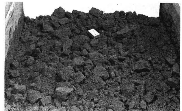
Bild 23. Bodenoberfläche nach der Bearbeitung mit der Scharfräse.
