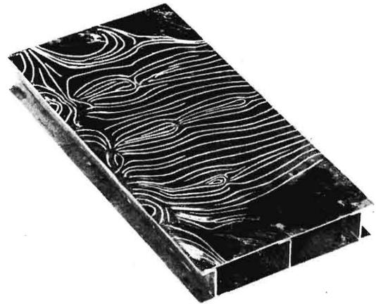
**Bild 55.** Dehnungslinienfeld an einem doppelten Blechboden mit eingepunkteten Z-Profilen (nach Kloth [11]).
