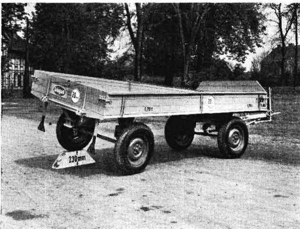
**Bild 14.** Gummifederter Ackerwagen in stark verwundenem Zustand. Eigenmasse des Wagens 600 kg verhält sich zur Nutzmasse 2,8 t wie 1:4,7.
