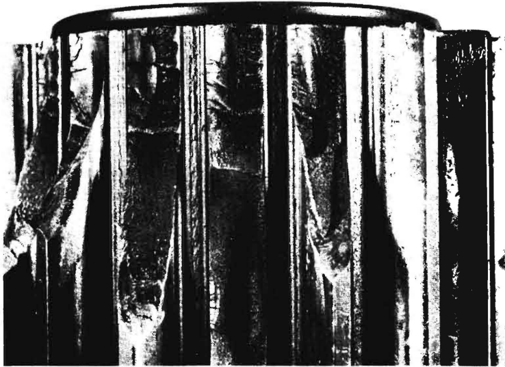
Bild 17. Bruchansicht des flammengehärteten Getrieberades. Die Brüche der Zähne sind durch Dauerbrüche im Zahngrund (Bild 16) eingeleitet worden. (natürliche Grösse)
