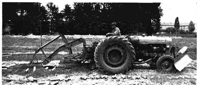
**Bild 19.** Der Fräskettenbagger „Trenchhog“ der Firma Arps, New-Holstein, Wisconsin, ist ein Schlepperanbaugerät.
