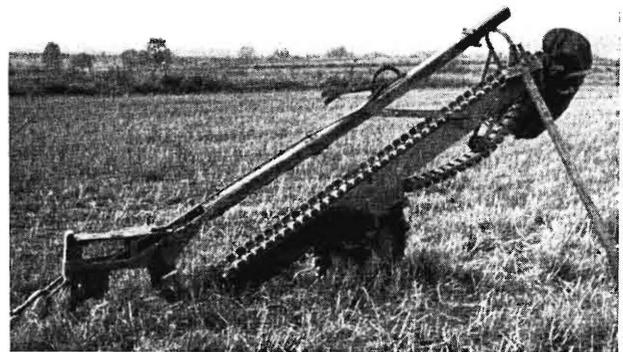
**Bild 10.** Aashamer-Drängerät der Firma Splide Rakkestad, Norwegen, hebt in mehrmaligem Hin- und Hergang Drängräben aus. Kettenantrieb durch Bodenrad.
