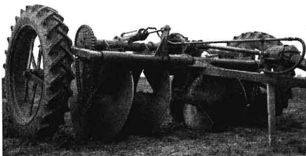
**Bild 21.** Holländ. Verfüllgerät mit zwei gegenläufigen Schnecken.
