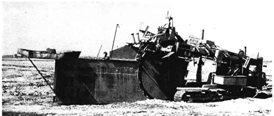
**Bild 17.** Fräsradbagger der Firma Barth, 's-Gravendeel, Holland. Leistungsfähiges Gerät in steinfreien Böden.
