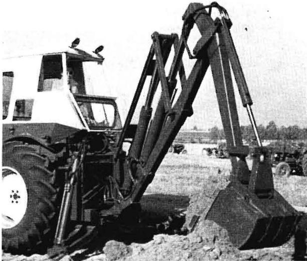
**Bild 12.** Löffelbagger „Dinkum“ der englischen Firma Whitlock Bros, Halstead, Essex, als Anbaugerät zum Fordson-Major-Schlepper. Vielseitig verwendbar, ortsbeweglicher Bagger.
