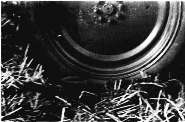
Bild 14. Seitenwandfaltung eines Reifens mit 0,4 atü Luftdruck auf Moorboden (zu Bild 13).
