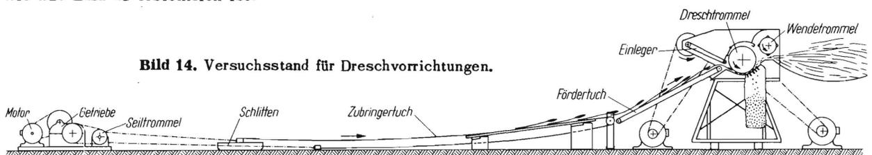
keit des Zubringertuches gesorgt werden. Letztere wurde durch Antrieb mit Hilfe eines Drahtseiles über eine Seiltrommel erreicht.
