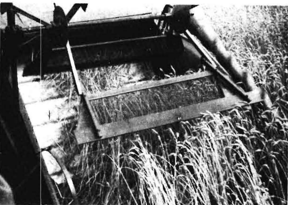
Bild 16 bis 18. Vorgang des Getreideeinzuges beim Längsflussmährescher.
