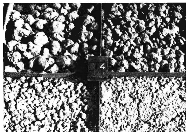
Bild 14. In vier Größenklassen sortierter Boden. Bei kleinen Krümelgrößen besteht die Gefahr der Verschlämmung des Bodens.
