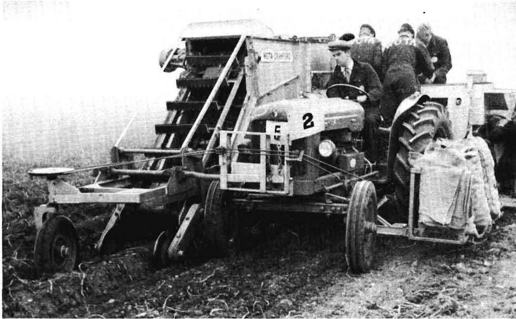
Bild 9. Angetriebene Scheibenseche am Kartoffelroder von Wota (England).
