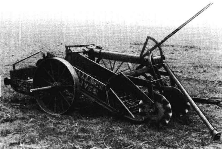
Bild 8. Scheibenseche mit gewelltem Rand am Sammelroder.
