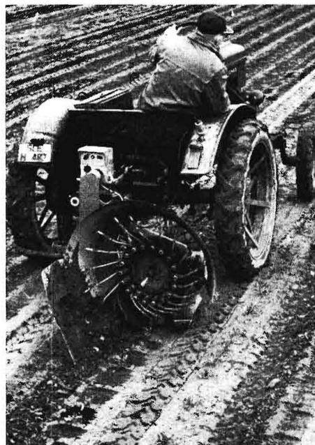
Bild 22. Fertó-Fähse, Vereinzlungsgerät.
