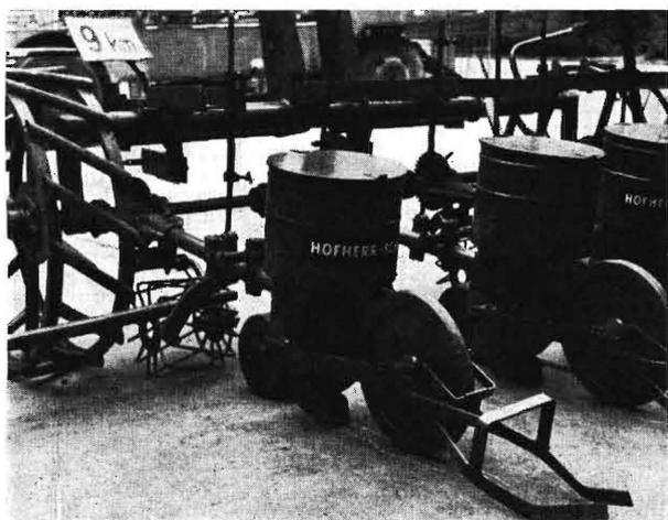
**Bild 17 und 18.** Multiculta als Sämaschine und Vereinzlungsmaschine.
