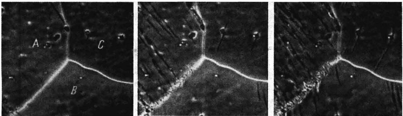
Bild 1. Ausbildung von Gleitspuren an der Oberfläche einer \alpha -Eisen-Dreikristallprobe in Abhängigkeit von der Beanspruchungsdauer nach Hempel, Kochendörfer und Hillnhagen [22]. (Phasenkontrastaufnahmen, Maßstab 200:1).
