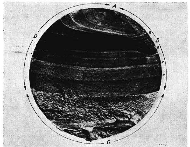
Bild 6. Dauerschwingbruch einer Exzenterwelle von 230 mm Durchmesser nach Pohl [26].
