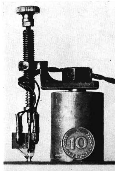
**Bild 39.** Induktiv wirkender Dehnungsaufnehmer mit magnetisch wirkender Aufspannvorrichtung.
