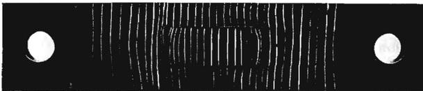
**Bild 53.** Das Dehnungslinienbild des in **Bild 52** dargestellten Zugstabes (Verkleinerungsmaßstab 1:5,5). Der Zugstab ist mit Maybach-Reißlack überzogen. Die senkrecht zur größten Dehnung aufgetretenen Risse sind mit weißer Tusche nachgezogen.
