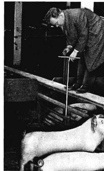
**Bild 4.** Schweinestall mit Flüssigfutteranlage. Die Dosierventile werden von einem Laufsteg aus betätigt.
