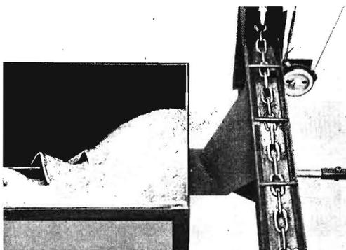
**Bild 12.** Das Schrot wird durch eine Förderschnecke von unten in den Kanal mit der Förderkette gedrückt.
