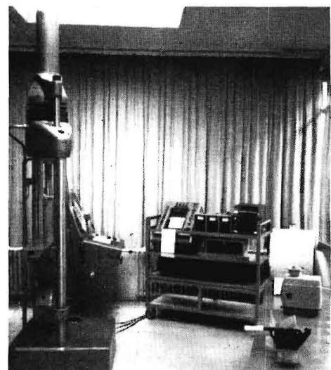
Bild 1. Versuchseinrichtung für die Verdichtung von Halmgütern im Preßzylinder.
