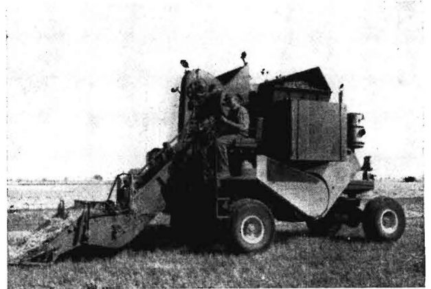
Bild 18. Aufsammel-Kolbenbrikettierpresse Cal-Cube der Firmen Johnson Farm Machinery Co. und Vaughan Mfg., Inc.
