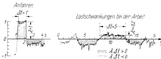
**Bild 21.** Beispiele für Dauer und Höhe von Überschreitungen der Vollast nach Meßschrieben vom Anfahren sowie während der Arbeit; die schraffierten Flächen zeigen etwa die dem Schwungrad entnommene bzw. wieder zugeführte Arbeit.
