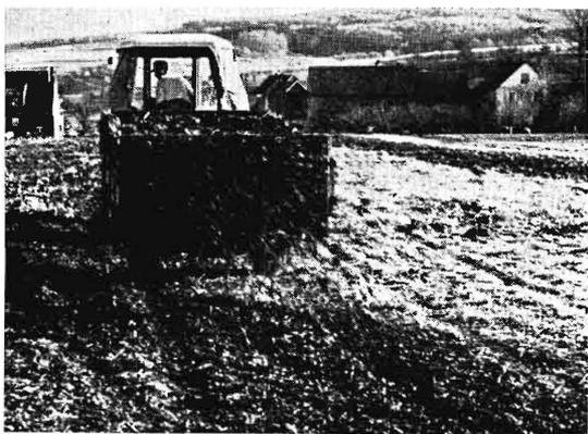
**Bild 11.** Bei einem Schmalstreuer verursacht Seitenwind eine asymmetrisch zur Längsachse des Wagens ausgebreitete Mistdecke.
