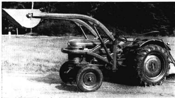
Bild 11. Versuchsschlepper I mit Frontlader-Meßeinrichtung. Der Frontlader wird von dem um den Schlepper herumgebauten Traggestell gehalten, das sich über vier Meßkörper nach Bild 10 am Schlepperrumpf abstützt.
