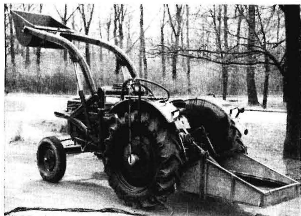
Bild 12. Versuchsschlepper I mit der Frontlader-Meßeinrichtung, den Schleifringen zur Übertragung für Drehmomentmessungen der Triebachse, der Anbauladekiste (mit Schlepperrumpf fest verspannt) und dem darin verschraubten Heckballast.
