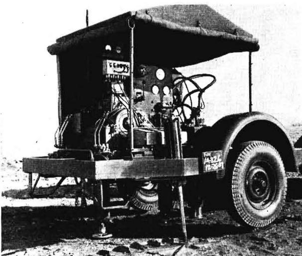
**Bild 28.** Bodenprüfgerät der Firma Caterpillar mit zwei Bodendruckstempeln und einem Ringschergerät.
