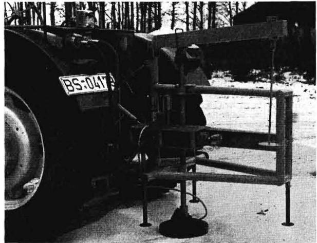
**Bild 29.** Anbau-Ringschergerät am Schlepper.
