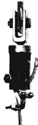
**Bild 6.** Wirkung der Seildrilling auf die Beanspruchung des Knotens durch Zwischenschaltung eines Kugellagers ausgeschaltet.
