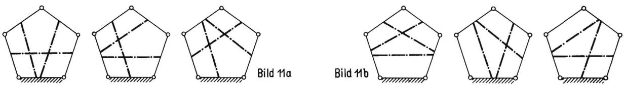
Bild 8 bis 11. Belastungstafel für das Gelenk fünfeck (61 verschiedene Belastungsfälle).
