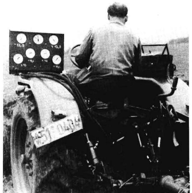
Bild 15. Die Messeinrichtung am Schlepper.
