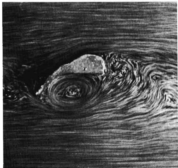
Bild 3. Umströmung einer Dreschtrommel-Schlagleiste. Die Anströmung kommt von links bzw. die Leiste bewegt sich nach links.
