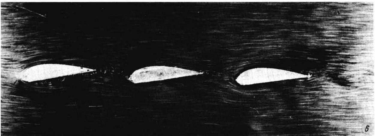
Bild 4 bis 6. Umströmung verschiedener Schlagleistenprofile. Die Anströmung kommt von links.
