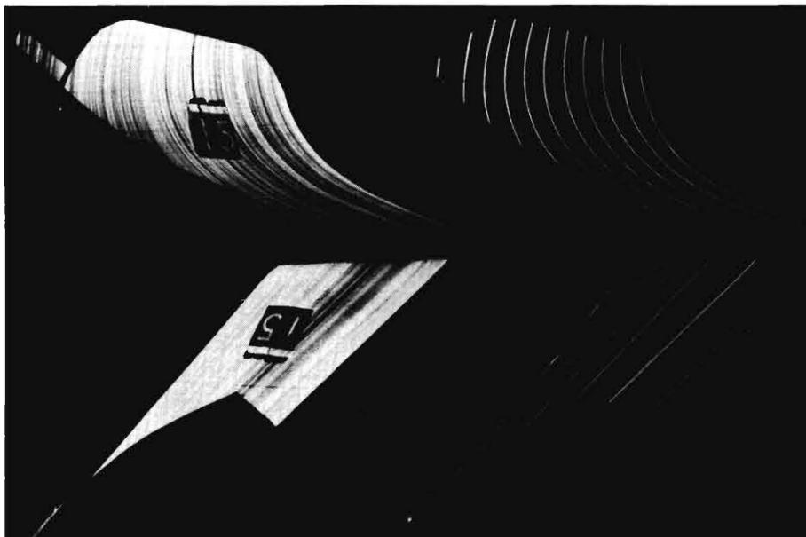
**Bild 3.** Aufnahme des Normkörpers M 25 mit dem Lichtschnittverfahren, links bei kontinuierlicher Bewegung des Streichblechwagens, rechts bei schrittweiser Bewegung von je 4 cm.
