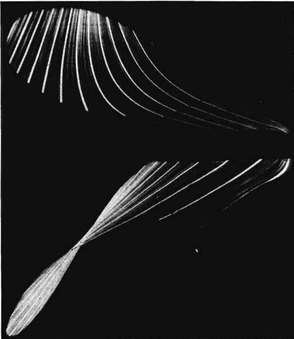
**Bild 4.** Aufnahme des Massey-Ferguson Semidigger 12 BAE 112 mit dem Lichtschnittverfahren. Die Lichtschnitte bei schrittweiser und kontinuierlicher Bewegung wurden in einem Bild überlagert.
