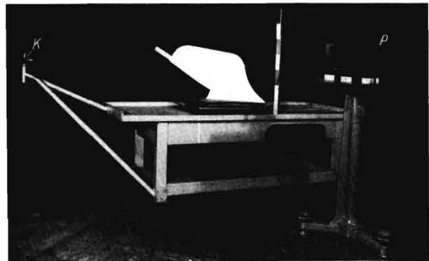
**Bild 2.** Einrichtung zur Aufnahme der Pflugkörperform nach dem Lichtschnittverfahren.
