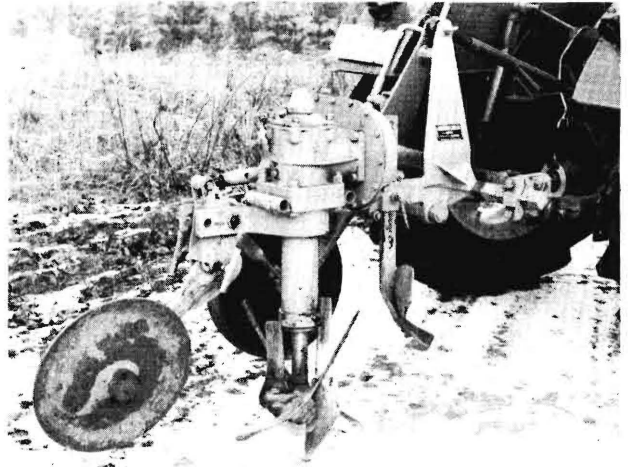
Bild 4. Italienischer Quirlpflug Aratore Civello als Anbaupflug für die Dreipunktaufhängung Modell P.M. 30/1957 (D.P. 884 581).
