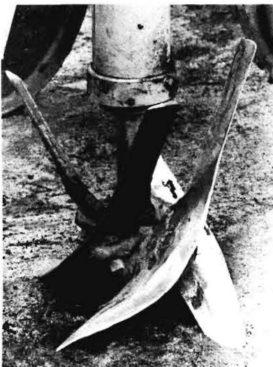
Bild 5 und 6. Werkzeugköpfe des Aratore Civello mit verschiedenen Messerformen. links: Meißelmesser rechts: Löffelmesser
