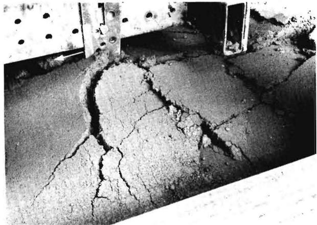
**Bild 5.** Bodenaufbruch vor und über einem Schar in der Bodenrinne.
