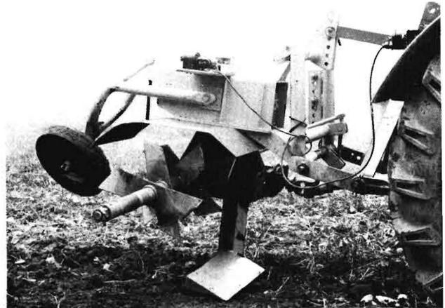
**Bild 14.** Schar-Fräsen-Kombination am Einkomponentenmesspflug zur Messung der Zugkraft (Längskraft) und des Zapfwelldrehmomentes bei Feldversuchen.
