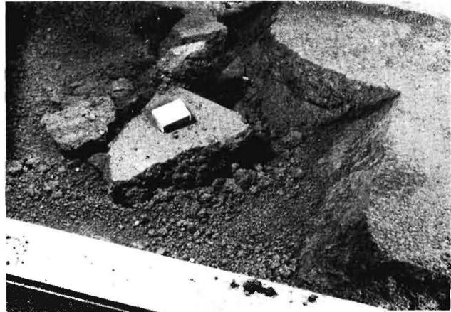
**Bild 15.** Abgetrennter Bissen des Rotorgraber-Werkzeuges nach Bild 14.
