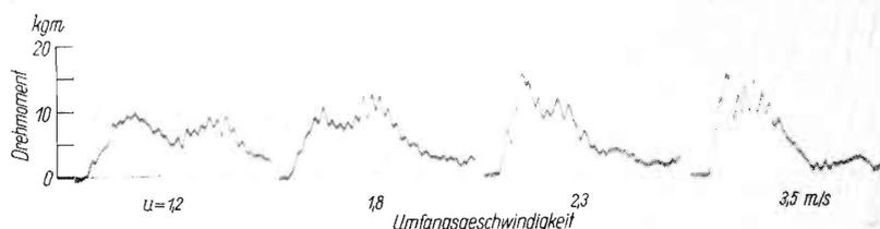
**Bild 22.** Drehmomentverlauf eines Rotorgraberwerkzeuges bei verschiedener Umfangsgeschwindigkeit.
