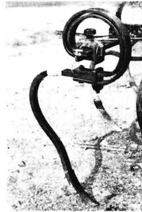
**Bild 7.** Feingrubberzinken E mit Reisserschar.
