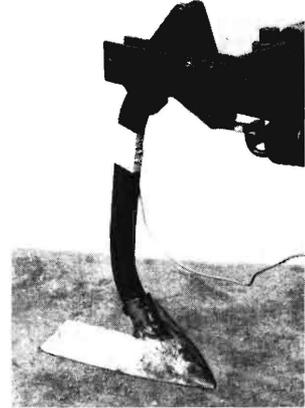
**Bild 3.** Starrer Werkzeugstiel mit 40 mm breitem Reisserschare (A-1). **Bild 4.** Spiralfederzinken mit 200 mm breitem Gänsefußschar (B-2). **Bild 5.** Arnszinken mit 200 mm breitem Gänsefußschar (C-2). **Bild 6.** Starrer, abgefederter Zinken mit 300 mm breitem Gänsefußschar (D-3).
