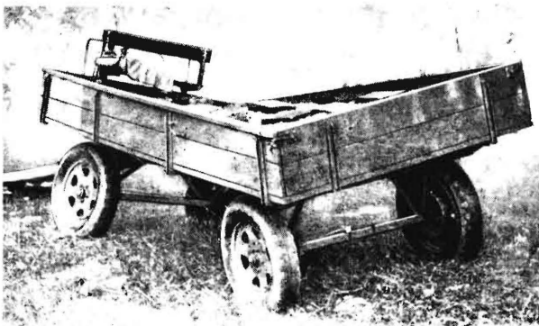
Bild 2. Verwindung eines Ackerwagens im Gelände. Spitzenbeanspruchungen treten z.B. beim Fahren über schlechte Feldwege mit tiefen Radschienen und beim Durchfahren von Gräben und Furchen auf [2].
