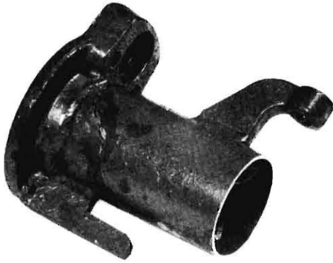
Bild 13. Dauerbruch an einem biegebeanspruchten Rohrrahmen infolge einer unvermittelten Querschnittsverstärkung des Rohres. Bruchbeginn genau in der Ecke der angeschweissten Nase. Daher soll man keine örtlichen Verstärkungen in hochbeanspruchten Biegezonan anbringen. Die Anschlüsse sind möglichst in die neutrale Biegezone zu legen.
