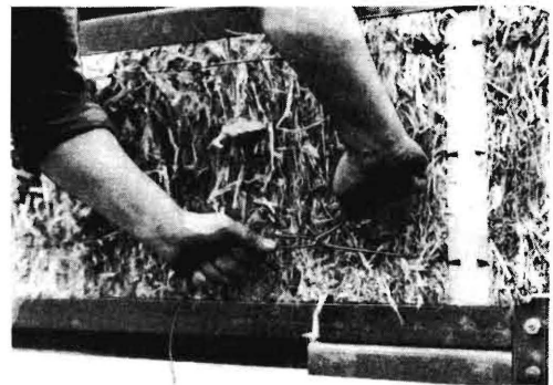
Bild 42. Handbindung von Draht mit Hilfe des Teilbrettverfahrens.
