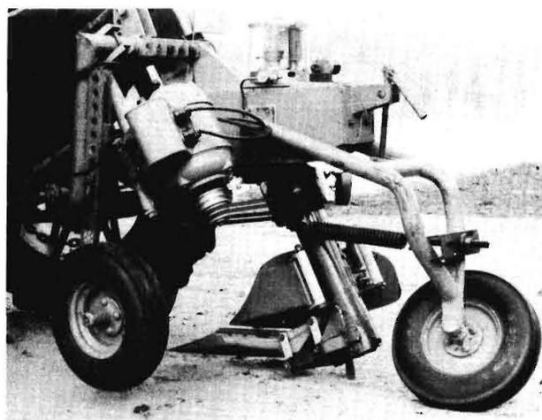
Bild 5. Schwingender Pflugkörper am Einkomponenten-Messpflug zur Messung des Zugwiderstandes in Fahrtrichtung.
