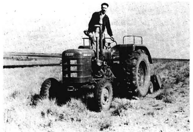
**Bild 11.** Schlepper mit Spatenegge auf Weideland, um das seegrasartige Unkraut als Gründung in den Boden zu bringen.
