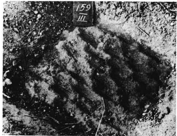
Bild 2. Fräsbissen bei verschiedenem Verhältnis von Umfangs- zu Fahrgeschwindigkeit. Fräsensdurchmesser 52 cm u Umfangsgeschwindigkeit v Fahrgeschwindigkeit
