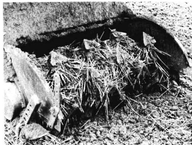
Bild 25 und 26. Versuchsfräse mit gänsefußscharartigen Werkzeugen, unten durch lange Stoppeln bei hoher Fahrgeschwindigkeit verstopfte Fräswalze.
