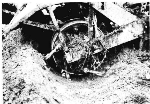
Bild 3 und 4. Das Osthaus -Anbaufräswerk (Hersteller: Hanomag , Hannover-Linden). Das rechte Bild zeigt sehr schön das bodenfreie Laufen dieser Fräse
