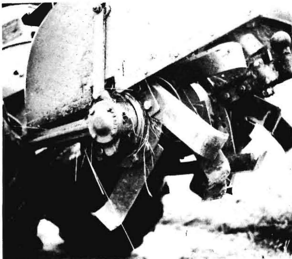
Bild 1. „Pionier“fräse – ein spezielles Gerät für den Forstbetrieb. (Hersteller: P. Mullikas, Quickborn/Holstein)
