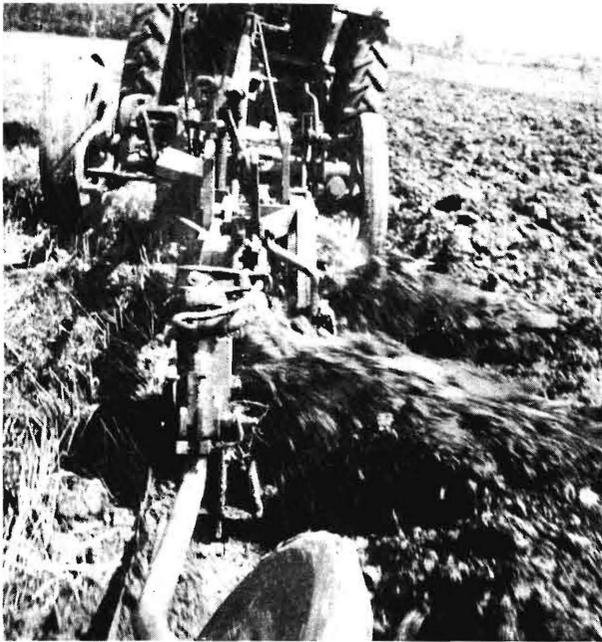
**Bild 17.** Der „schüttende“ Pflug. Durch sanften Druck, durch Scheren und durch Beschleunigen ergeben sich natürliche Bodenaggregate.
