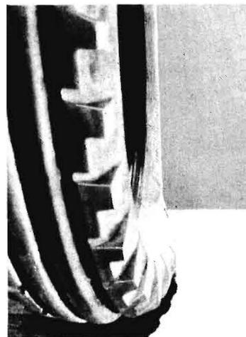
**Bild 5.** Verformung des talseitigen Reifens 5,50 – 16 AS Front an der Stufenachse.
