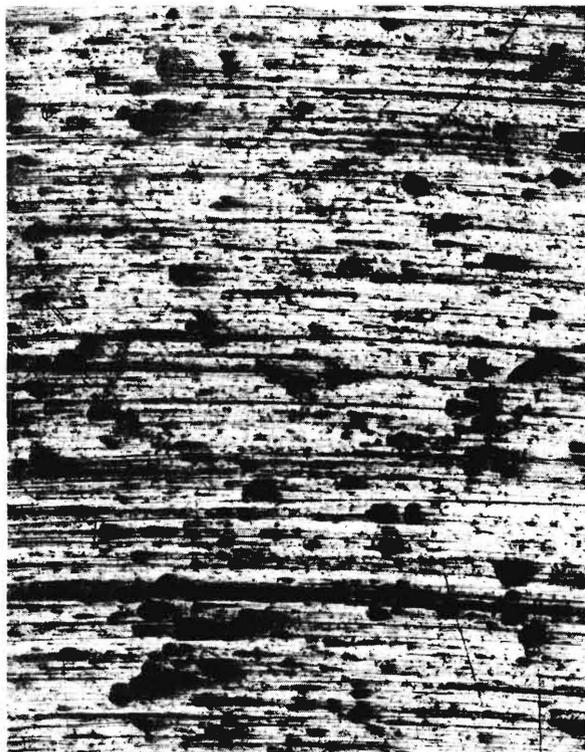
Bild 22. Oberfläche eines feingeschlichteten Stahlringes bei 10-facher Vergrösserung (die Reibriefen verlaufen genau in derselben Richtung wie die Drehriefen).
