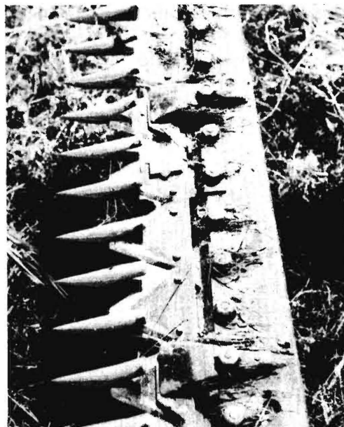
Bild 1. „Grasbärte“ unter dem Messerhalter.
