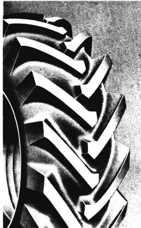
Bild 22. Profilierung eines U.S. Rubber-Reifens.
