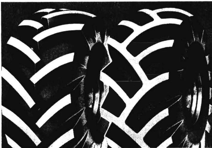
Bild 20. Zusammenhängende und offene (open center) Profilierung von *Firestone*-Reifen.
