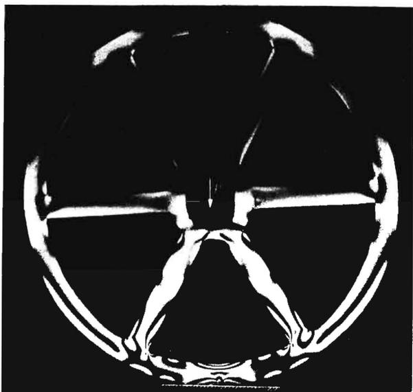
Bild 51 bis 53. Rad mit 4 Speichen in drei Bewegungsphasen bei gleicher Belastung.
