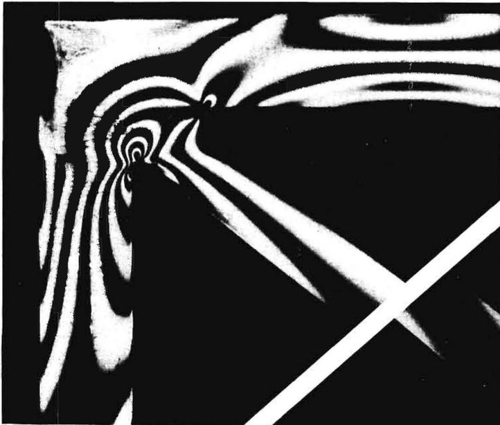
Bild 49 und 50. Vergrößerung der Isochromatenbilder zweier Ecken aus dem Rahmen Bild 48.
