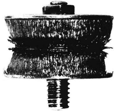
Bild 6. Magnetfilter mit angesetzten Eisen- und Stahlteilchen aus einem hydraulischen Kraftheber.
