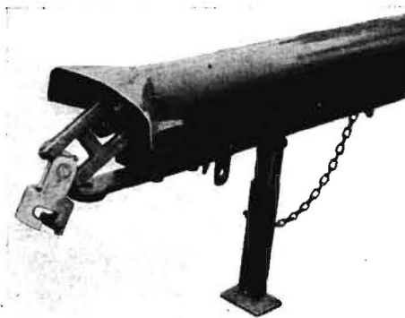
Abb. 5: Zapfwellenantrieb in Kurzanhängung. Durch Verwendung eines Doppelgelenkes entsteht praktisch nur ein Dreh- und Gelenkpunkt. Beste Gelenkigkeit und einwandfreier Schutz durch kleine feste Schutzschirme wird möglich. Anbau an einen normalen 22-PS-Schlepper mit Z. F.-Getriebe
