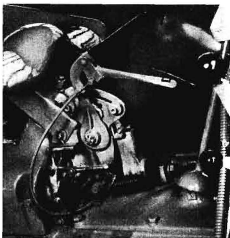
Abb. 16: Der hydraulische Kraftheber von Allgaier, Uhingen Lizenz André Morgen, eingebaut im AP 17, A 122 und A 133 H = Handsteuerhebel, L = Handbetätigung für langsames Ablassen
