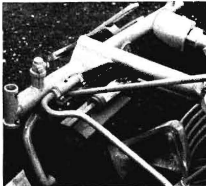
Abb. 1: Vorderwagen einer Feldmaschine aus verwindungssteifen Rohren mit sehr steifer Eckverbindung zwischen Längs- und Querträger und gutem Anschluß der senkrechten Faustlager für die Schleppräder
