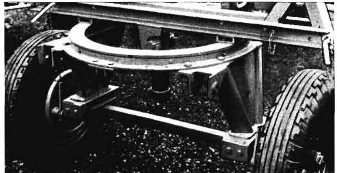
Abb. 13: Achsbüchse eines Akerwagens als Preßteile von hoher Festigkeit. Die Feder-elemente aus schubbeanspruchten Gummiklätzen fügen sich organisch zur Achse hin ein
