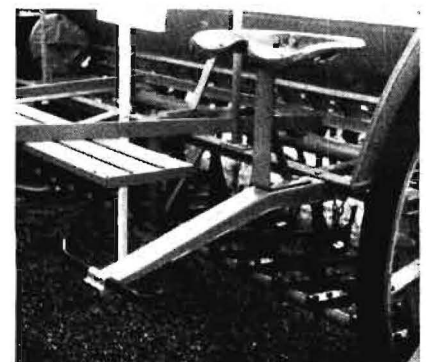
Abb. 7: Fußstütze an einer Drillmaschine aus U-förmig abgekantetem Blech
