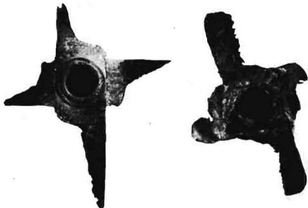
Abb. 6: Bei Dauerversuchen zerstörte Messer
