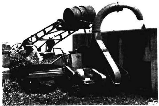
Abb. 8: Zuführung von Melasse durch Gefälle aus höhergestelltem Faß in das Gebläsegehäuse
