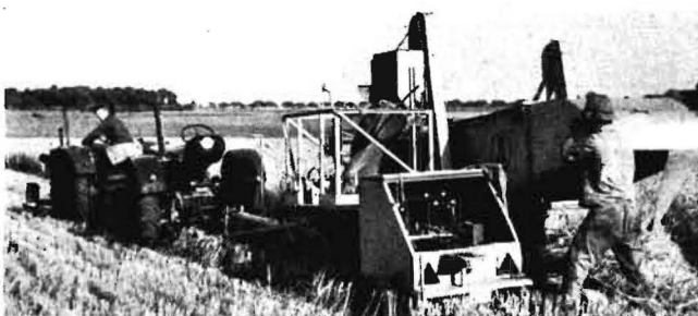
Abb. 11: Elektronische Meßeinrichtung zur Ermittlung des Zug- und Zapfwellenkraftbedarfes
