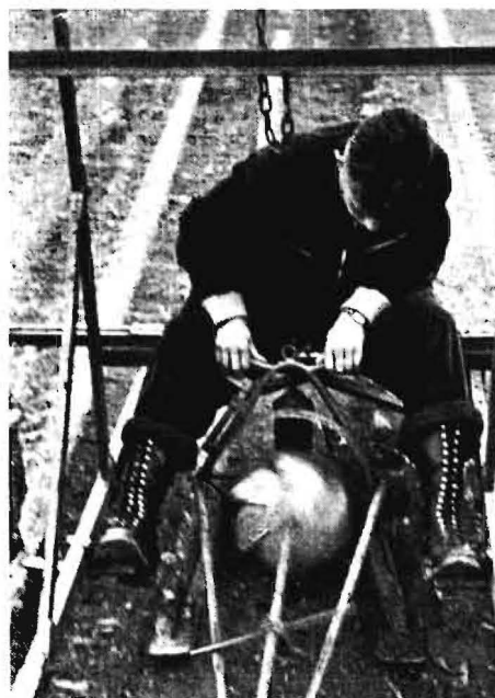
Abb. 2: Halbautomatisches Vereinzelungsgerät der Firma Magnier bei der Arbeit. Die rotierende, mit Schlagleisten versehene Frässscheibe wird durch die mitfahrende Bedienungsperson gesteuert und bedient
