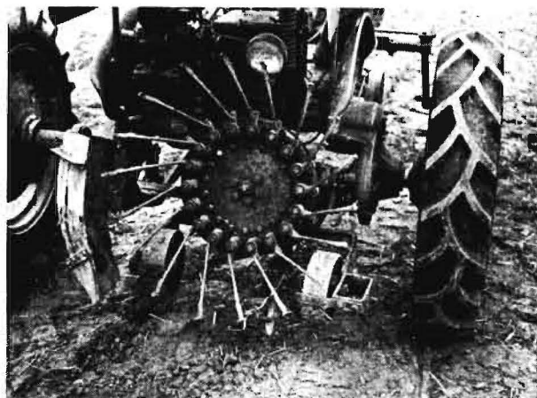
Abb. 5: Frässtern des vollautomatischen Vereinzlungsgerätes von Ferté, hinten an einem Kleinschlepper angebaut. Unter dem Frässtern ist der Tastbügel zu sehen, der die zu bearbeitende Reihe vorher abstastet
