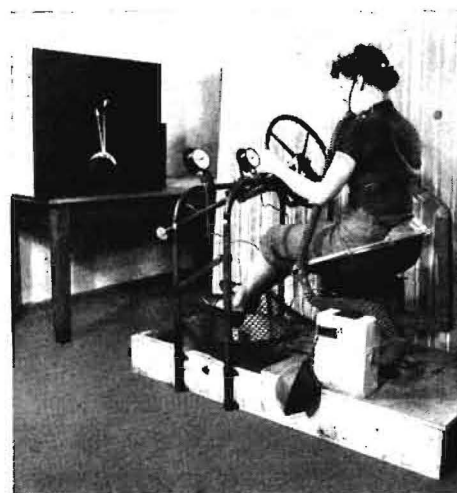
Abb. 13: Versuchsstand zur Ermittlung der optimalen Winkelstellung des Lenkrades
